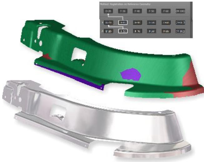
トリム工程後に測定したスプリングバックに基づくD20工程の見込み補正。結果は90%が公差レベル内です。
