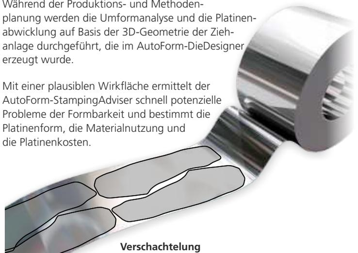
Die AutoForm-StampingAdviser-Software macht es möglich, die Einbettung und Verschachtelung zu berechnen und zu optimieren. Wenn diese Platinenberechnungen mit dem AutoForm-CostEstimator gekoppelt sind, wird eine Balance zwischen Material-, Werkzeug- und Produktionskosten erreicht.
