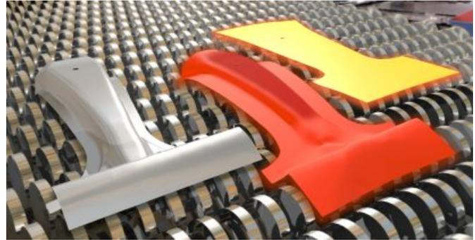
caliente. Con este plug-in, también se puede simular el proceso de templado por zonas, lo que permite la ingeniería de piezas estampadas con propiedades de resistencia local específicas. En función de los resultados de AutoForm-PhaseChange plug-in, puede mejorar la precisión de la simulación de crash teniendo en cuenta la distribución real de la deformación plástica en los componentes de conformado en caliente.
