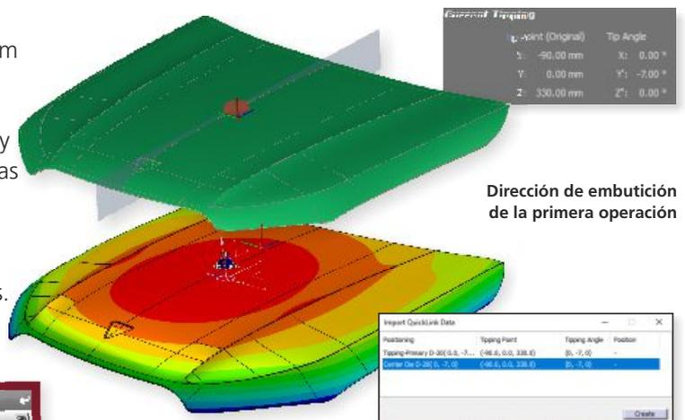
AutoForm-QuickLink<sup>for</sup>CATIA permite la interoperabilidad entre AutoForm Forming y CATIA. La información del proceso, como la posición de la pieza, la orientación, las direcciones del carro y las geometrías, se puede compartir.
