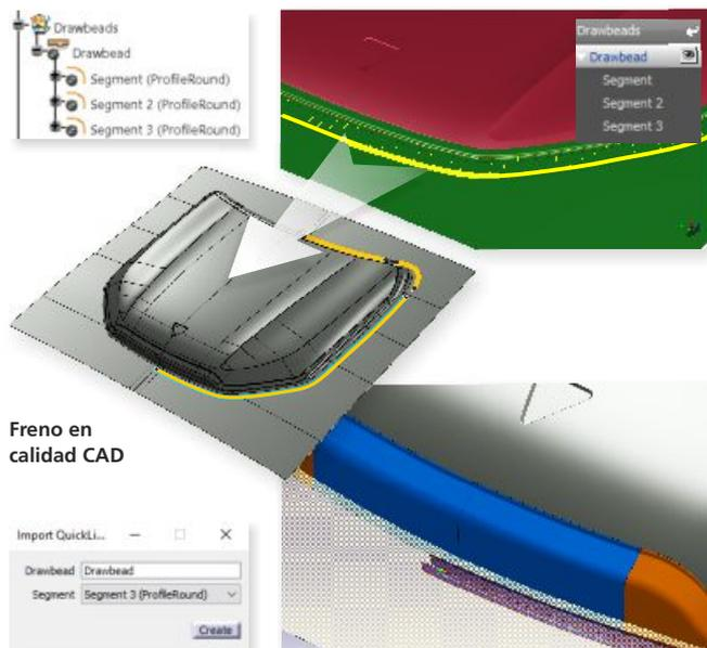
Con AutoForm-QuickLink<sup>for</sup>CATIA, los parámetros de freno se pueden importar a AutoForm-ProcessDesigner<sup>for</sup>CATIA para soportar eficientemente la generación de frenos en CAD.
