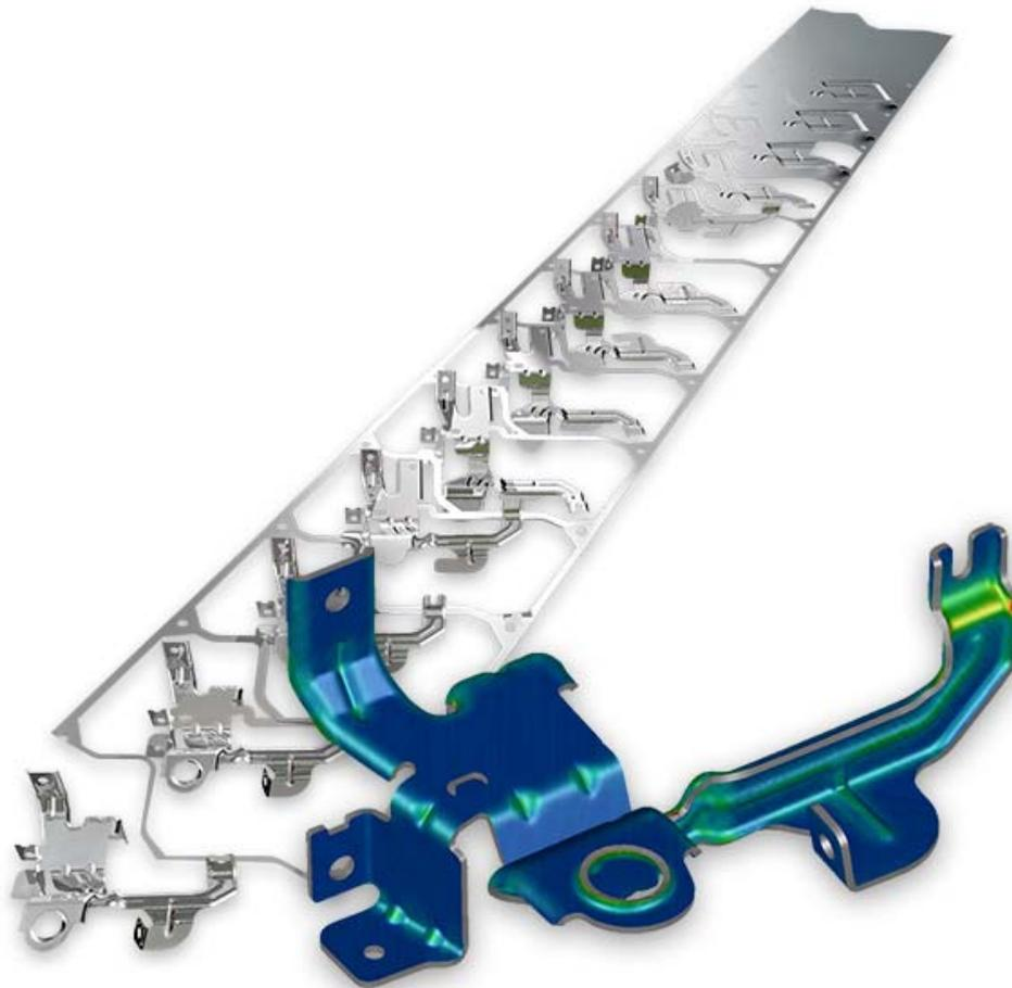
Программное обеспечение AutoForm позволяет моделировать весь процесс прогрессивной штамповки.
