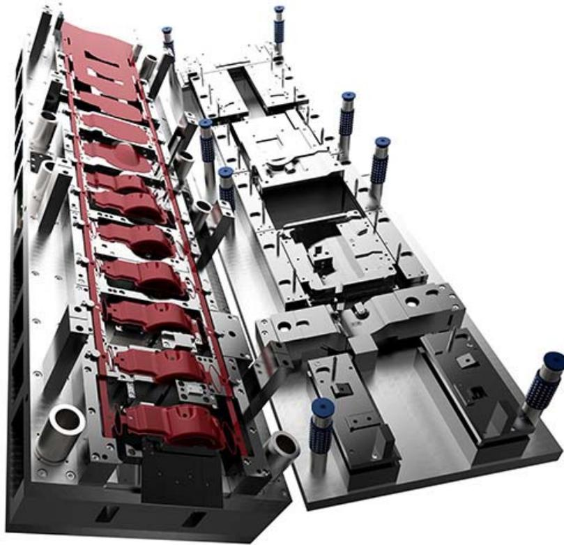
Отображение штампа для прогрессии с использованием Logopress3 и SOLIDWORKS®.
