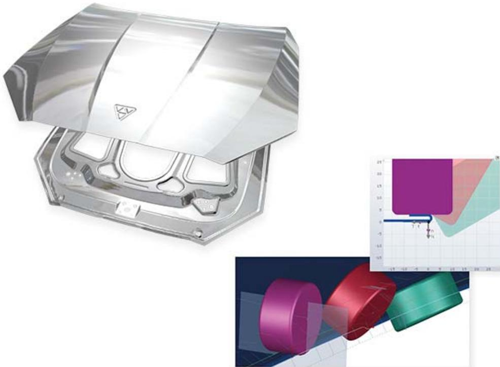
Схема процесса зафланцовки роликом
