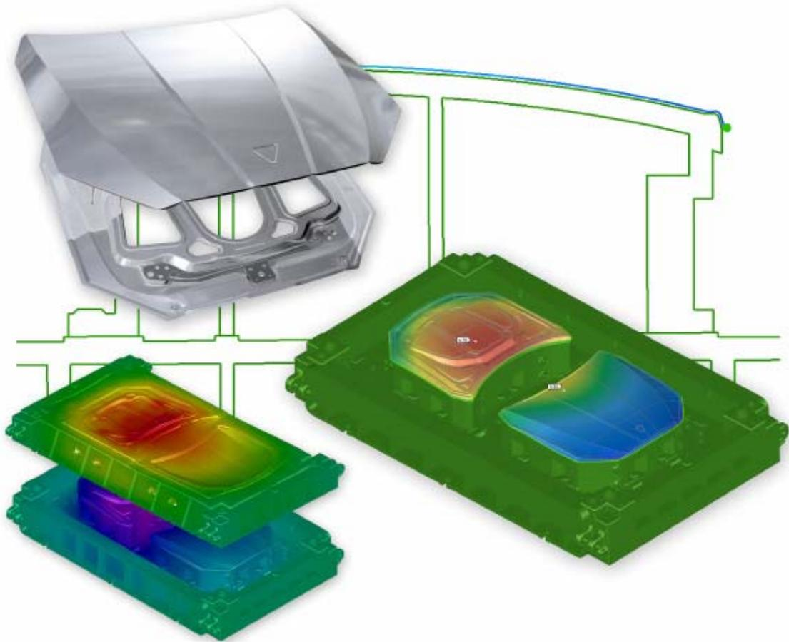
AutoForm-ToolDeflect で弾性金型たわみを効率的に解析し、見込み補正することができます。
