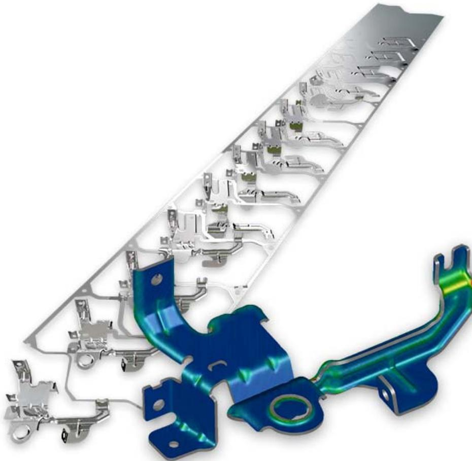
AutoForm ソフトウェアでは、順送金型のプレス成形工程全体をシミュレーションできます。
