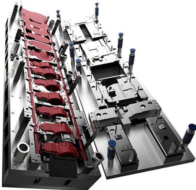
Rendering dello stampo progressivo usando Logopress3 & SOLIDWORKS®.
