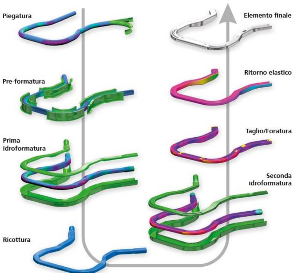
AutoForm Hydro consente agli utenti di portare a termine un completo processo virtuale di idroformatura attraverso tutti gli step richiesti, quali la piegatura, preformatura, ricottura, idroformatura, calibrazione, taglio, foratura e calcolo del ritorno elastico.
