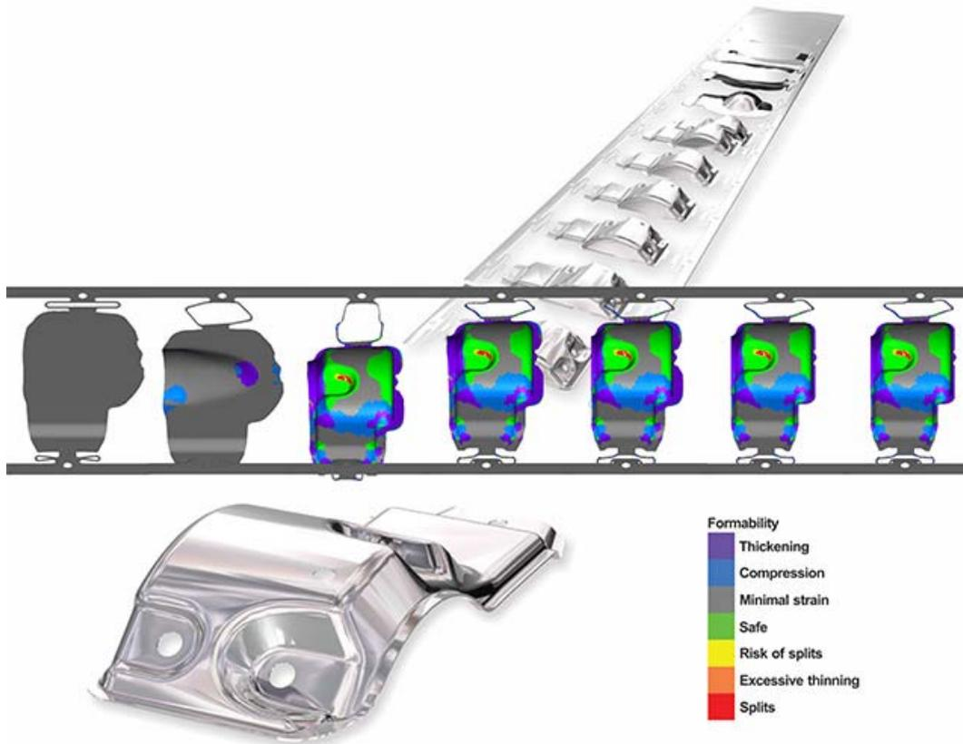
Logopress ProgSim permet une simulation précise du formage, au cœur des outils progressifs, basée sur une approche incrémentale.
