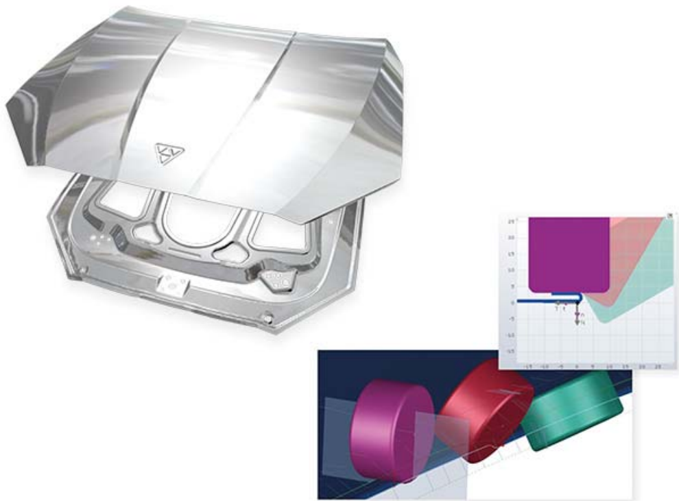
Concept du process de sertissage à molette
