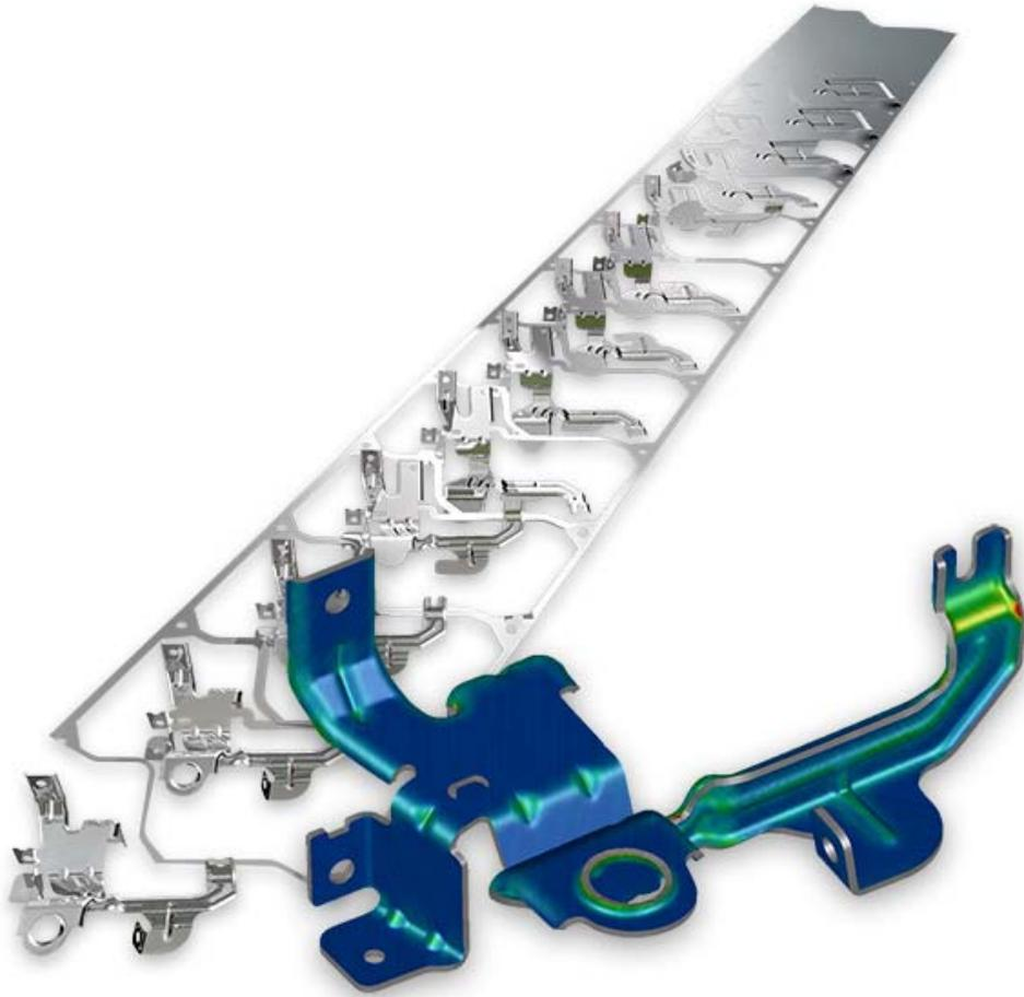
El software de AutoForm permite al usuario simular el proceso completo de estampado de matrices progresivas.
