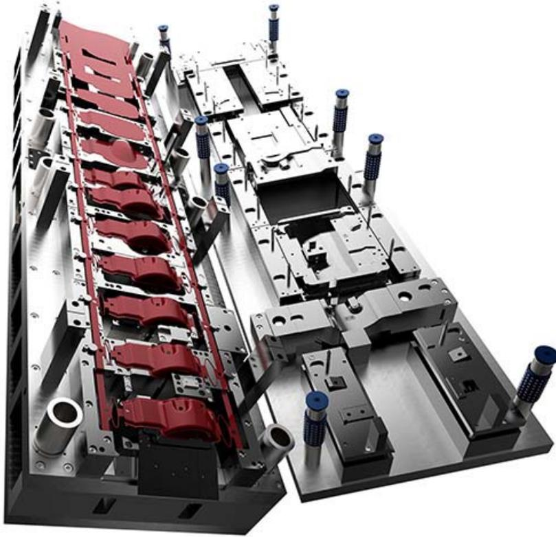
Renderizado de matrices progresivas, utilizando Logopress3 & SOLIDWORKS®.
