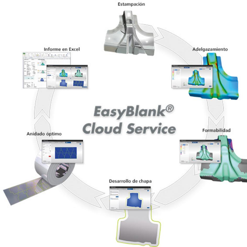
EasyBlank Cloud Service permite la determinación rápida del formato de chapa, una evaluación temprana de la viabilidad y la estimación del coste del material.
