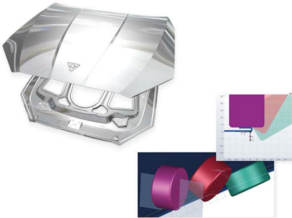
Concepto del proceso de engrapado por rodillo
