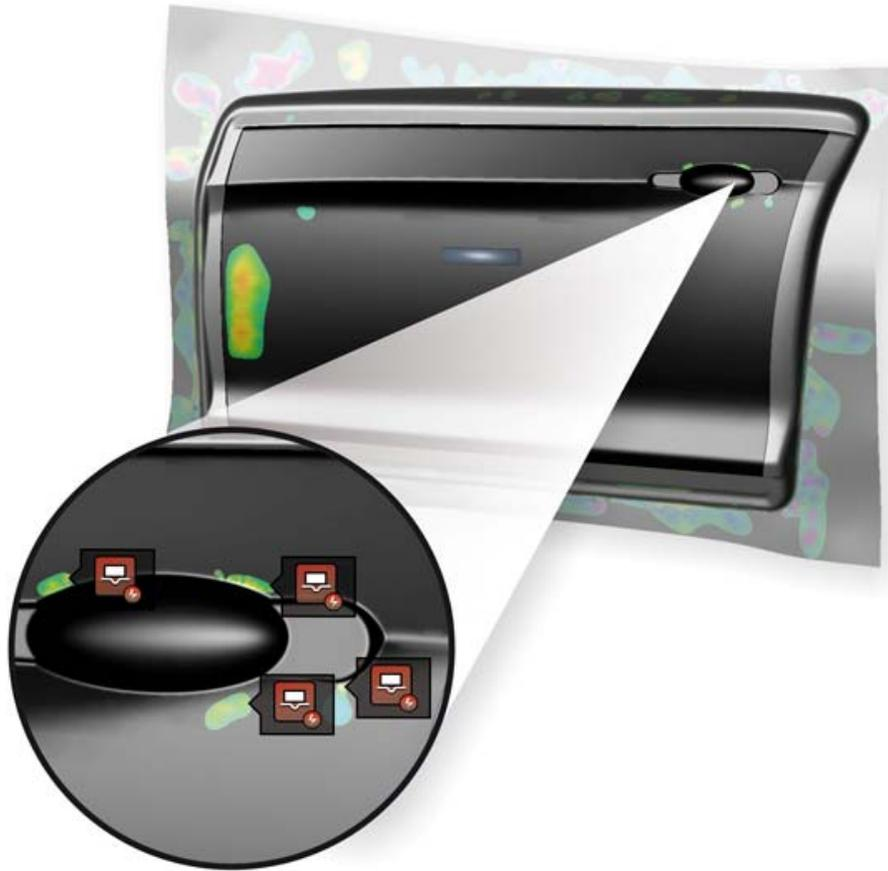
El método de análisis stoning digital permite una fácil visualización de las imperfecciones superficiales.
