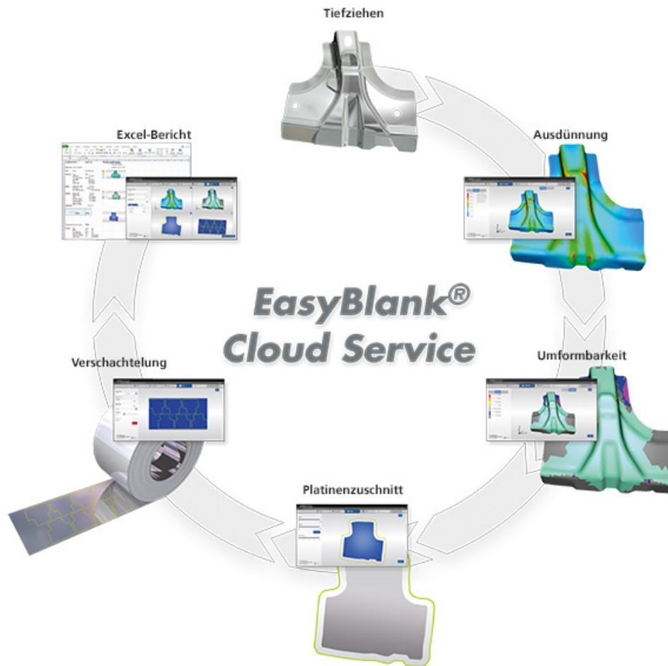
Der EasyBlank Cloud Service ermöglicht die schnelle Bestimmung der Plattenform, die frühzeitige Machbarkeitsbewertung und Materialkostenschätzung.
