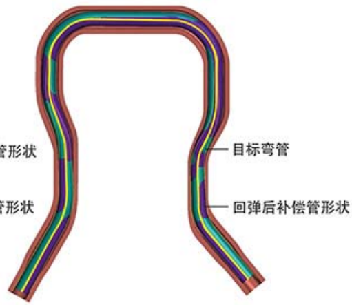
补偿弯曲工序的回弹
