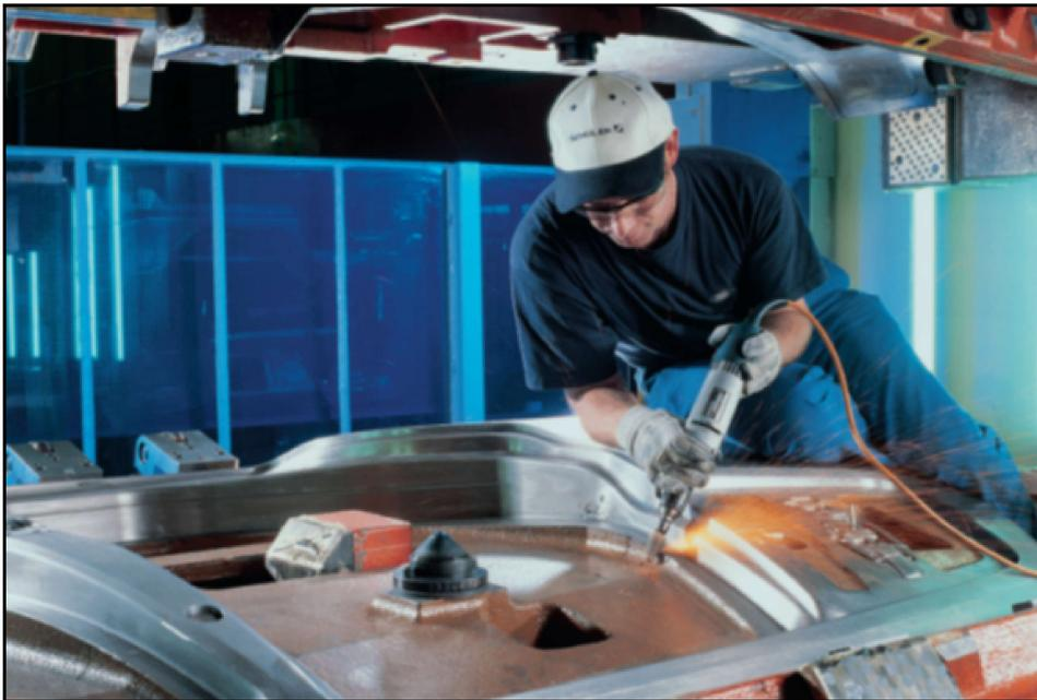
Imagem 02 - Ferramenteiro aliviando regiões utilizando ferramentas específicas e técnicas apropriadas.
