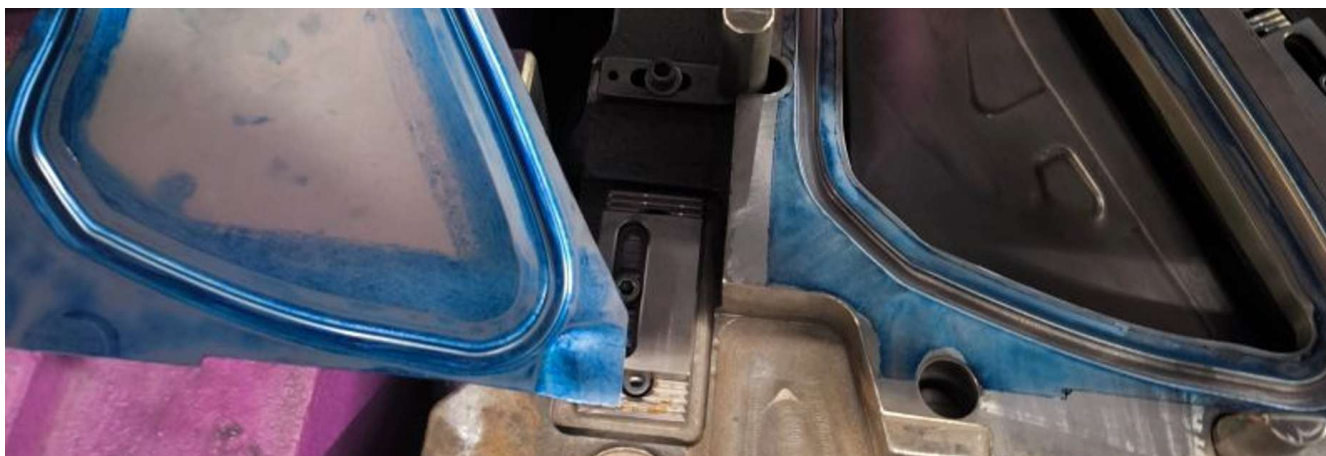
Figura 4 – Exemplo de um quadro de pressão real no momento de fechamento do prensa-chapa
