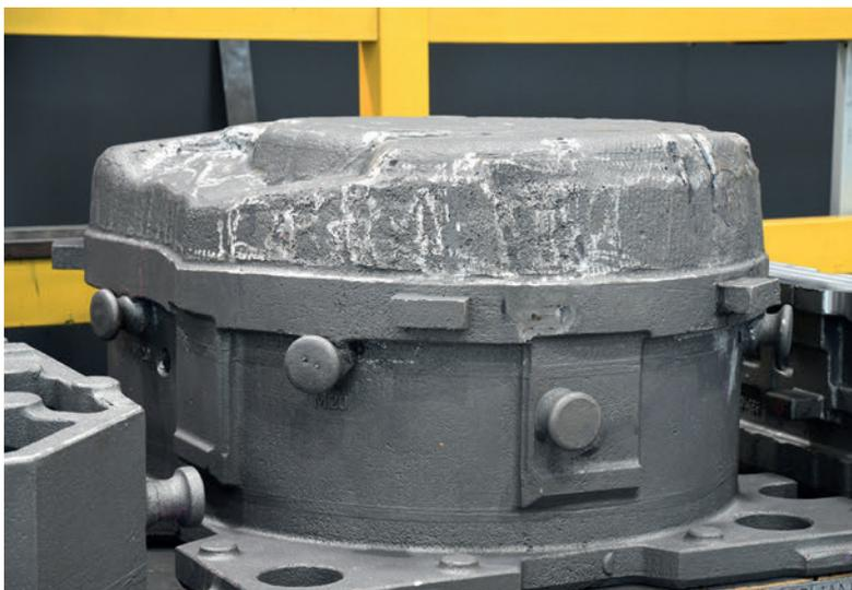
Aus diesem Gussrohling wird das Werkzeug für ein Radhaus hergestellt, für das Wesoba die Rückfederung mit dem AutoForm-Compensator kompensiert hat
