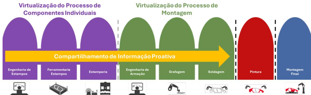
Figura 4. Processo proposto para o ciclo de desenvolvimento de peças metálicas.
