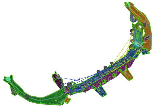
**Figura 9.** Diferentes caminhos de sequenciamento de solda aplicados à simulação de montagem.
