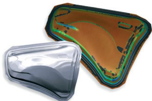
Figura 4 – Aplicación de un modelo de fricción de TriboForm en la embutición de una pieza
