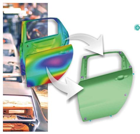
d'évaluer et d'optimiser les positions des points d'assemblages, ainsi que la séquence d'assemblage (séquentiel, simultané) en tenant compte des principaux facteurs influant sur les déviations de l'ensemble assemblé.
