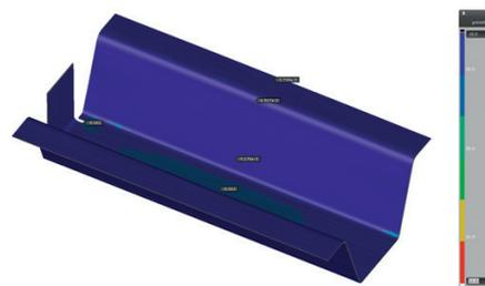
Figura 4 – Afinamento na espessura da chapa em percentual.
