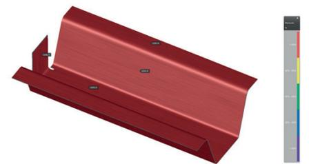
Figura 6 – Percentual de transformação martensítica na peça após conformação.
