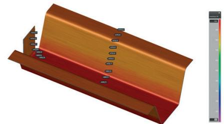
Figura 5 – Resistência mecânica à tração da peça após conformação.
