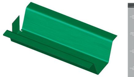
Figura 3 – Resultado da simulação referente ao risco de enrugamento.
