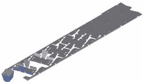
Imagen de una banda para un troquel progresivo realizada con AutoForm Forming R8 a través de la importación de las herramientas.
