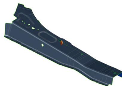
Figura 1: Reforço da coluna B de um automóvel nacional em produção (descaracterizado)
