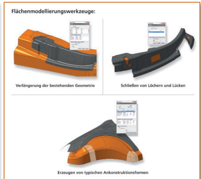
Flächenmodellierungswerkzeuge - die Werkzeugkasten zur komplexen Freiformflächen in Catia ist auf lediglich drei speziell entwickelte Werkzeuge reduziert.
