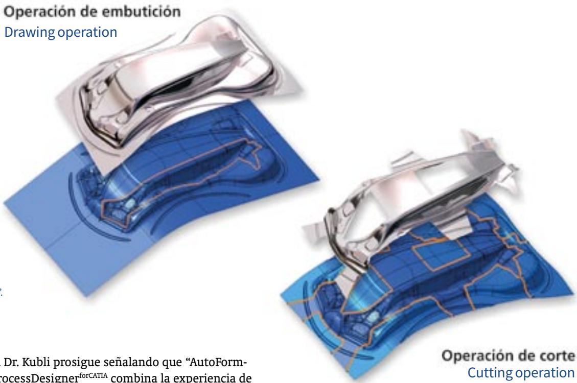
El Dr. Kubli prosigue señalando que “AutoForm-ProcessDesigner<sup>forCATIA</sup> combina la experiencia de AutoForm en el conformato de chapa metálica con las potentes funcionalidades únicas de diseño de CATIA V5. Completamente integrado en el entorno de CATIA V5, este software ofrece un nuevo nivel de velocidad y facilidad de uso”.
