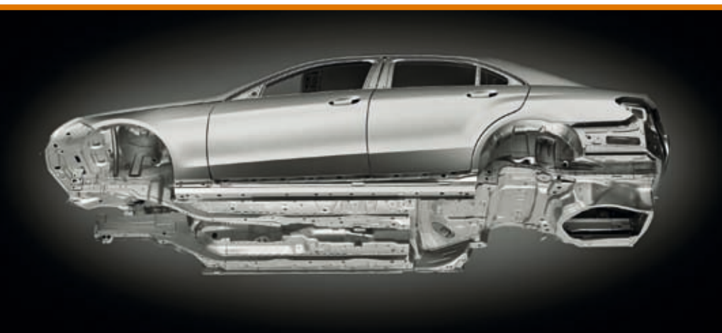
Bei der neuen E-Klasse setzt Mercedes-Benz an zahlreichen Stellen hoch- und ultrahochfesten Stahl ein.
