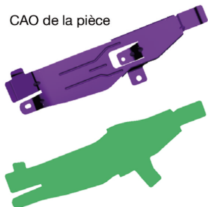
Géométrie de la pièce mise à plat avec AutoForm-OneStep
