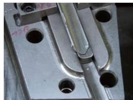
Das Aufsprungverhalten der Zierleiste ist deutlich zu sehen. Über eine entsprechende Rückfederungskompensation wird die gewünschte Bauteilform erreicht.
