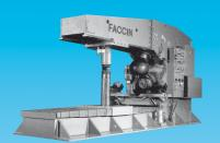
Bördelmaschinen, Kümpelpressen und Manipulatoren Blechdicke 5 – 50 mm Durchmesser bis 8000 mm
