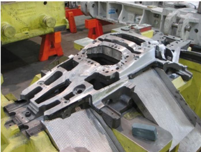
Die Beschnittabwicklung erfolgte aufgrund einer Beschnittanalyse in der AutoForm Tooling and Tryout Solution.
