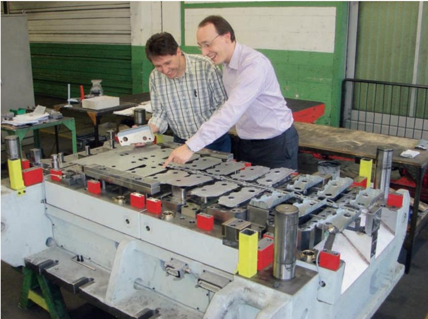
**Armin Schmid (l), Leiter CAD/CAM der Werkzeugbau Laichingen GmbH und Michael Kerausch, Application Engineer AutoForm Engineering Deutschland GmbH, haben gut lachen. Der Beschnitt für das mit AutoForm-Trim gerechnete Schliessblech war auf Anhieb innerhalb der Toleranz.**
