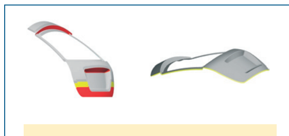
BILD 2. SIMPLER EFFEKT: Indem man die Arbeitsrichtung ändert, verschwinden die im linken Bildteil noch vorhandenen Hinterschnitte
