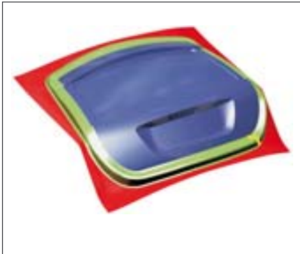
Die Ankonstruktion (grün) verbindet das Blechteil (blau) mit dem Blechhalter (rot). Interaktiv lassen sich die Profile, welche die Ankonstruktion bestimmen, einfach modifizieren.
