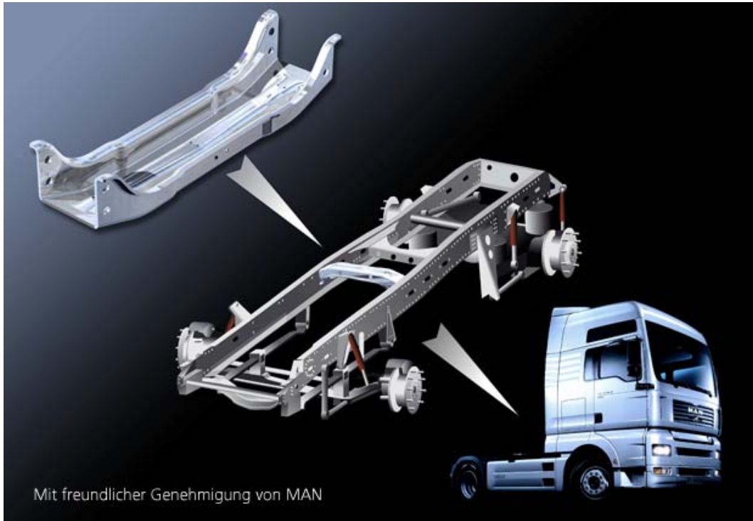
Im Sattelschlepperrahmen (TGA) verbauter Querträger
