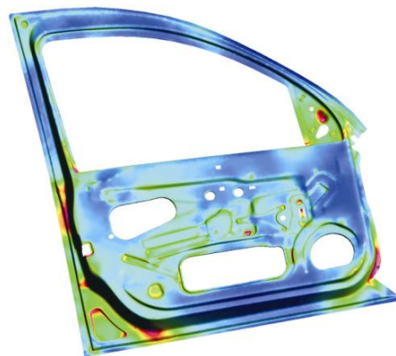
Umformsimulation einer Fahrzeugtür (mit freundlicher Genehmigung von Opel)
