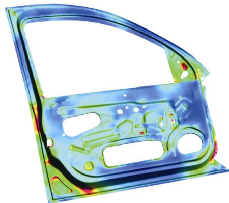
Simulation d'emboutissage d'une portière de voiture (avec l'aimable autorisation d'Opel)
